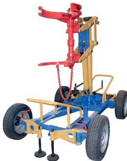
Рисунок 4 – Приспособление для демонтажа-монтажа цилиндров подвески карьерных самосвалов БЕЛАЗ-75710
