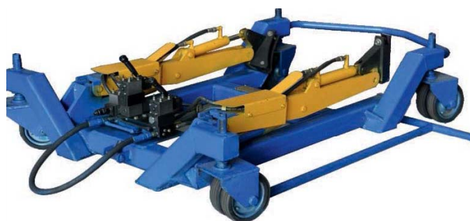
Рисунок 5 – Приспособление для снятия и установки главной передачи
