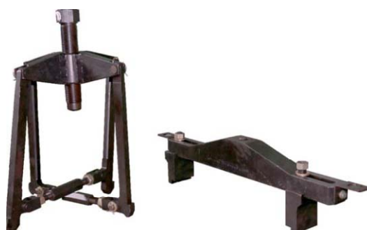
Рисунок 2 – Приспособление для монтажа-демонтажа цилиндров опрокидывающего механизма
