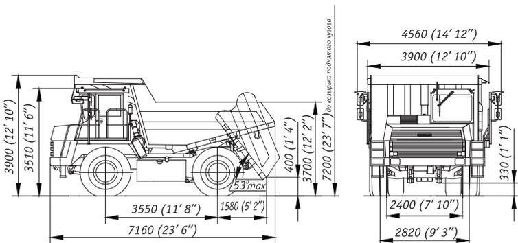
\*Габаритные размеры указаны для базовой комплектации самосвалов
